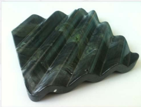
Figure 1 : Module de stockage thermique en céramique issue de coproduits inorganiques industriels.
