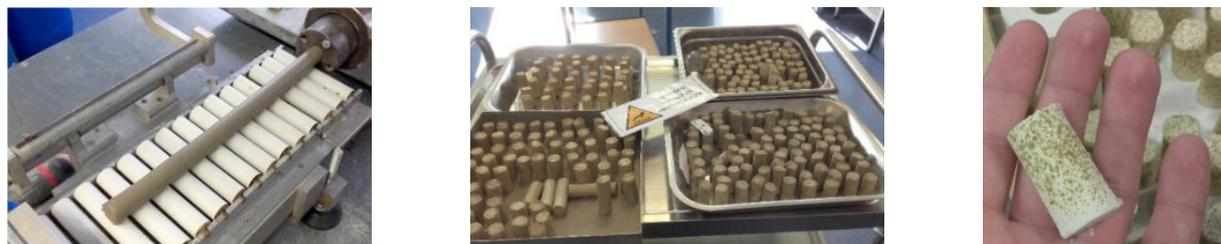
Figure 2 : Production de pellets cylindriques par extrusion/frittage d'un mélange de mâchefer d'incinérateur et d'argiles SD.
