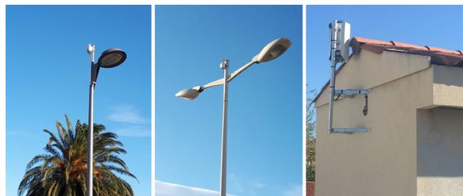
Figure 3 : deux des pyranomètres et le PSI 4 installés à Villeneuve-de-la-Raho, près de Perpignan.
