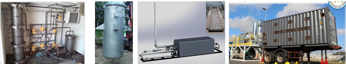
Figure 6 : de haut en bas : Démonstrateur (hors isolation) 10 kWh de stockage : 500 kg de quartzite, HTF = huile de colza. La cuve thermo-cline de la centrale Microsol-R: 6 T de céramique, HTF = huile synthétique Jarytherm. Vue 3D du stockage air/céramique de 30 kWh et photo de l'intérieur de la veine d'air : 300 kg de céramique, HTF = air à 800°C. Vue extérieure de l'Ecostock échelle 1 réalisé par Ecotech Ceram.
