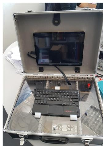
Figure 15: Système de caractérisation I-V transportable développé par l'équipe d'une puissance de 800W.
