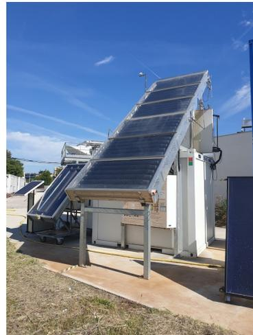
Dispositif solaire de production autonome de froid actuellement en cours de test pour le maintien à 25°C d'abri technique de relais Telecom opérant en zone chaude désertique
