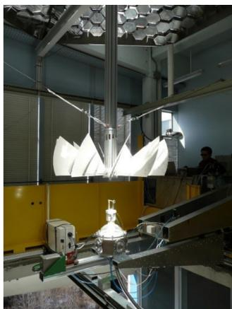
Figure 1 : REHPTS au foyer du four solaire de 6 kW
