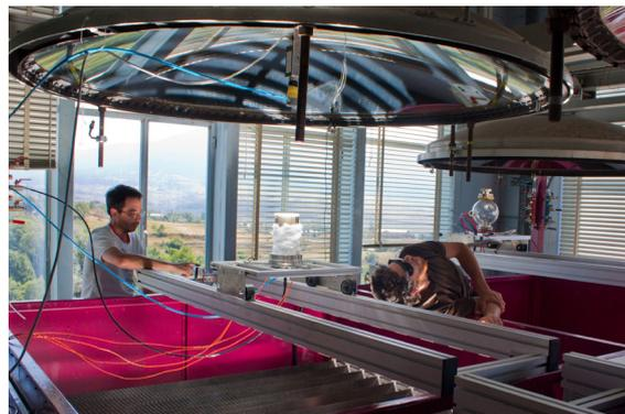
Figure 5 : Caractérisation thermique de céramique avec l'un des fours solaires des Verticales.
