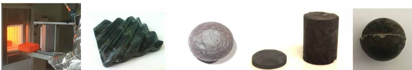
Figure 1 : Différentes céramiques issues de coproduits inorganiques industriels par voie pétrurgique : plaque plissée (amiante), sphère (cendre volante), cylindre et sphère (laitier). Dimension caractéristique de 3 à 10 cm.
