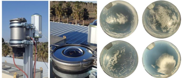
Figure 1 : le PSI 3 installé à Perpignan, sur le toit du laboratoire PROMES, et quelques images à haute dynamique.
