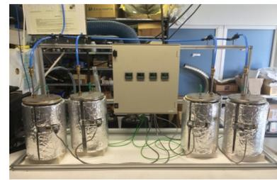
Fig. 5 : Banc de test de compatibilité des céramiques.
