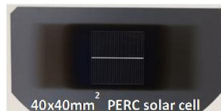
Figure 7: Cellule PERC de 40x40 mm<sup>2</sup> avec la couche antireflet et passivante SiNx :H déposée par plasma à la pression atmosphérique. (p<sub>max</sub>=19,9%),
