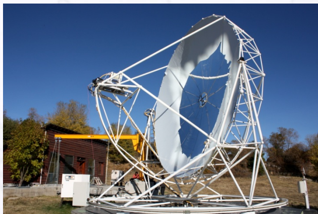
Figure 4 : Calorimétrie sur la parabole EuroDish en tant que four solaire.
