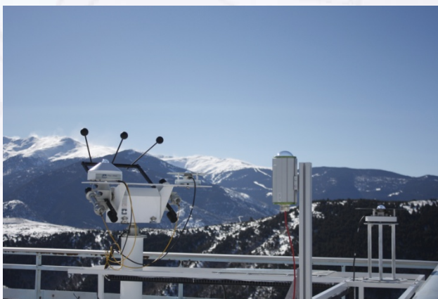
Figure 7 : Station météo principale d'Odeillo : pyréliomètres et pyranomètres sur robot de suivi solaire, caméra hémisphérique de suivi de nébulosité.
