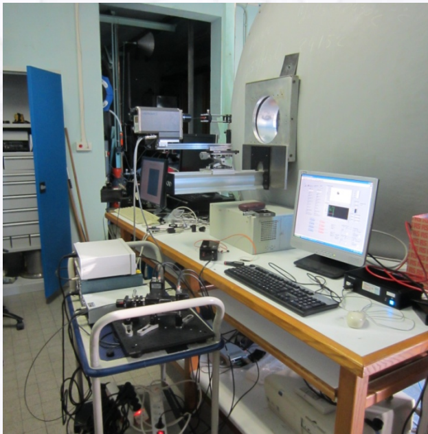
Figure 8 : Test d'un prototype de pyromètre bicolore « solarblind » au « Bastion ».
