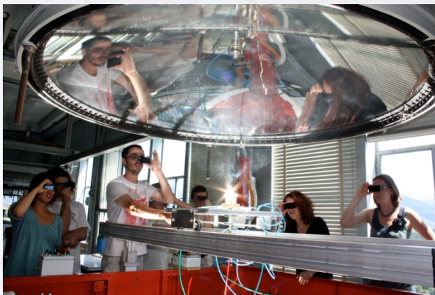
Figure 5 : Démonstration de fusion à des étudiants sur l'une des paraboles à axe vertical.
