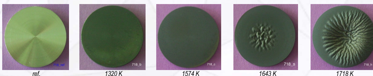
Figure 1 : Photos des échantillons d'Inconel 718 avant et après oxydation en conditions plasma d'air
