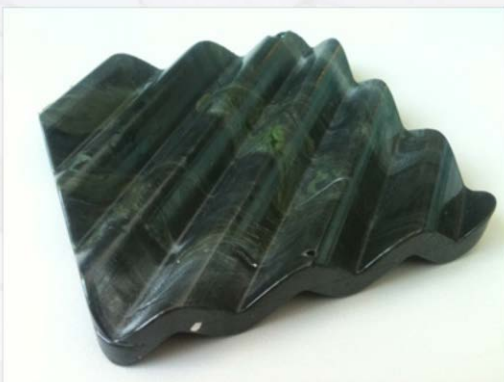
Figure 1 : Module de stockage thermique en céramique issue de coproduits inorganiques industriels.
