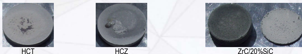
Figure 6 : Images de trois échantillons traités sous air pendant 20 min. à 2200 K. Pour l'échantillon ZrC/SiC, la couche d'oxyde s'est complètement détachée du substrat pendant le refroidissement.
