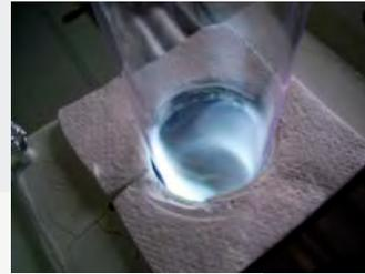
Figure 9 : Réacteur solaire MESOX au foyer du four solaire de 5 kW et image du plasma de  $\text{CO}_2$
