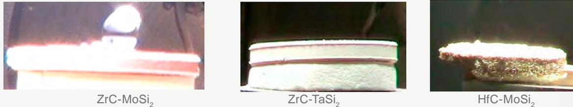
Figure 2 : Captures vidéo au bout de 15 min. d'oxydation à 2000 K sous air des échantillons de différentes compositions
