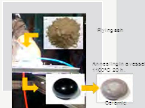
Fig. 2: Vitrification de cendres volantes sous flux solaire concentré. La céramique est obtenue par recuit.
