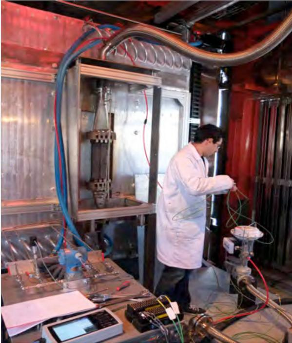
Figure 3. Test d'un module en céramique au foyer du concentrateur de 1MW
