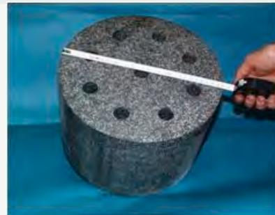
Fig. 6 : Composite PCM/ENG pour la protection des récepteurs solaires (ANR Solstock).
