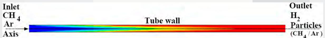
Figure 9. Distribution de température de l'écoulement dans le réacteur tubulaire de décomposition du méthane.
