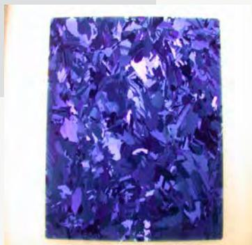
Figure 13 : Dépôt a-SiCN:H élaboré en PACVD basse fréquence sur wafer silicium polycristallin.
