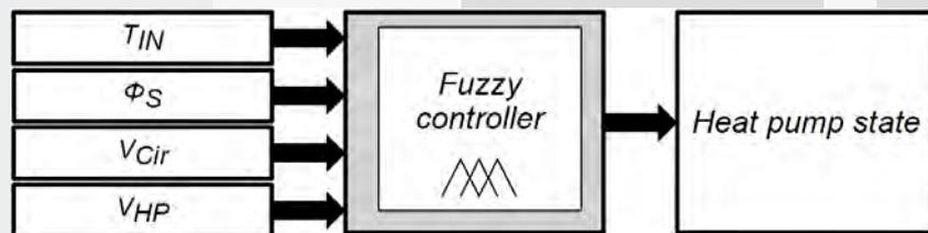
Figure 4. Structure du contrôleur flou proposé.
