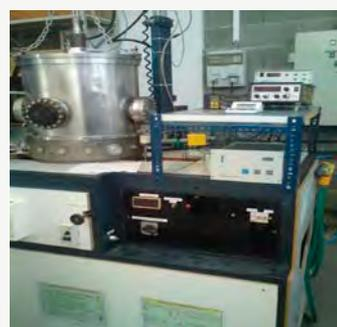
Figure 6 : Procédé de pulvérisation RF-magnétron pour réaliser des dépôts à partir de cible nanostructurée.
