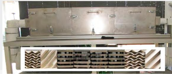
Figure 4: Banc d'essai de stockage/déstockage d'énergie sur matériaux recyclés (900-300°C). Vue de la conduite d'air intérieure équipée de mélangeurs statiques et de plaques planes de stockage.
