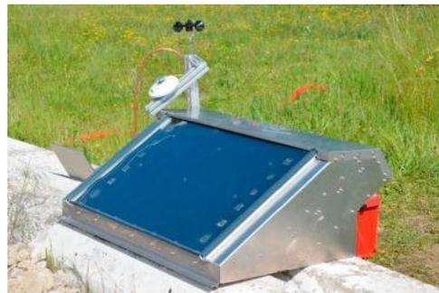
Capteur autostockeur avec MCP
